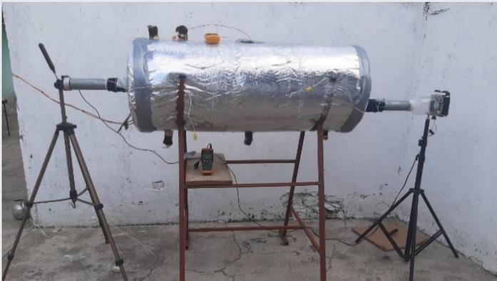
Figura 6. Modelo físico de intercambiador de calor agua aire. Fuente: Elaboración propia.
